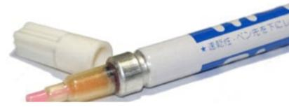
描いているうちにインクの出が悪くなったら、ペン先を本体側に押しやるとインクが再充填……なのだが、時としてドバツと溢れ、基板上がインクだらけに。でもまあ、基板へのインクの食付きには満足できたし、最初としては上出来だったといえる。
